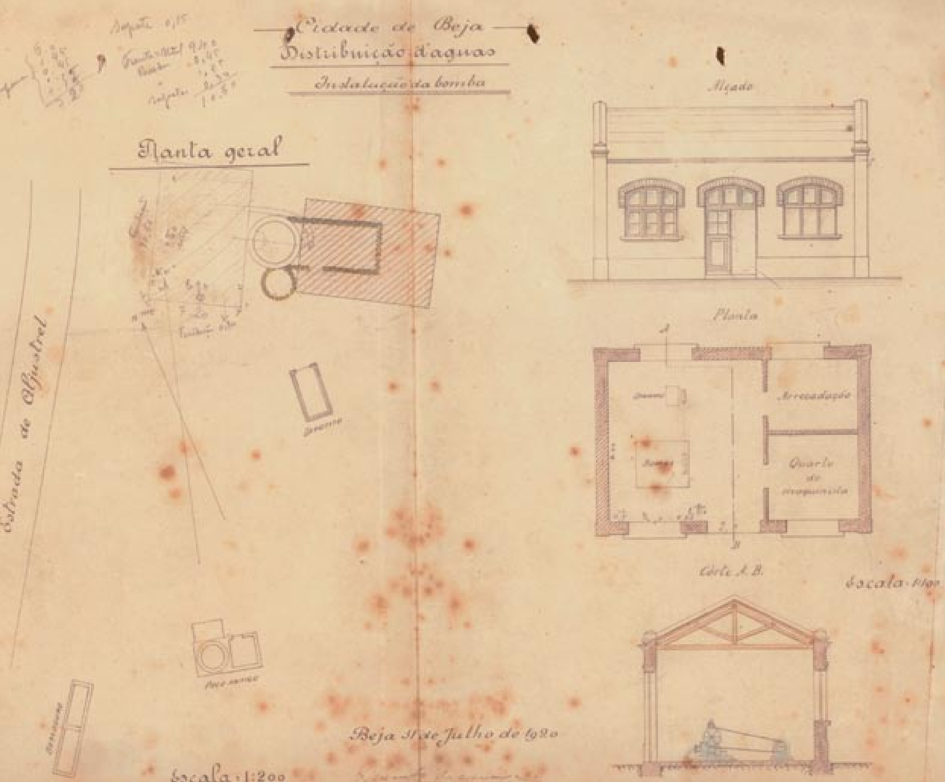
FIG. 48 Desenhos para a construção de uma casa para a bomba e estação elevatória do Poço de Aljustrel, propostos no projecto de 1920.
